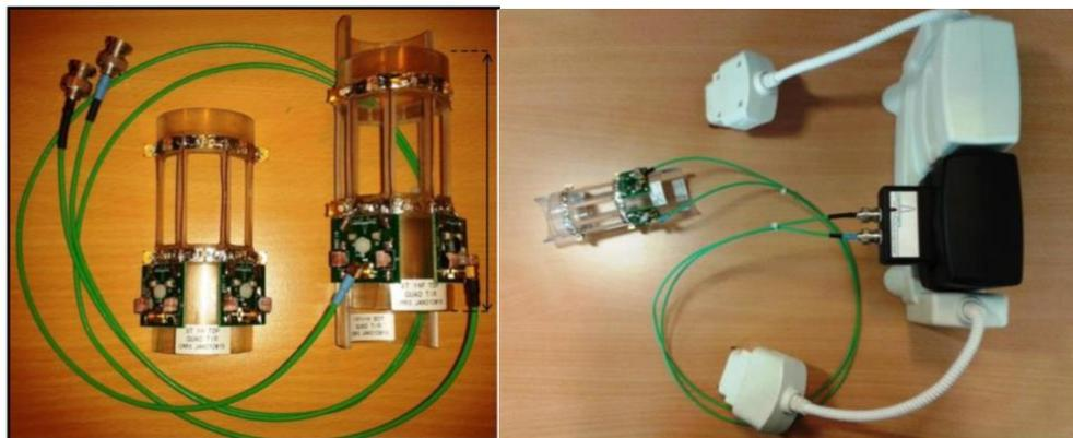
Figure 16 Tiré de : Doussot, 2016. Antenne proton et fluor avec l'interface permettant l'acquisition d'image fluor et proton
