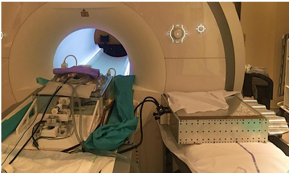
Figure 13 Système HIFU-IRM-compatible avec le transducteur à gauche équipé de l'antenne et du système de monitoring et anesthésie de la souris. A droite le générateur.
