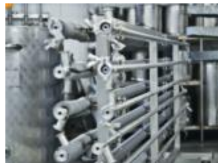
La technologie du projet TurbuHeat repose sur un traitement thermique par échangeurs tubulaires du petit-lait. L'équipe du professeur Beyrer a ainsi développé des tuyaux de différentes géométries pour une microparticulation optimale des protéines de lait et l'élaboration de poudres de lait variées.
