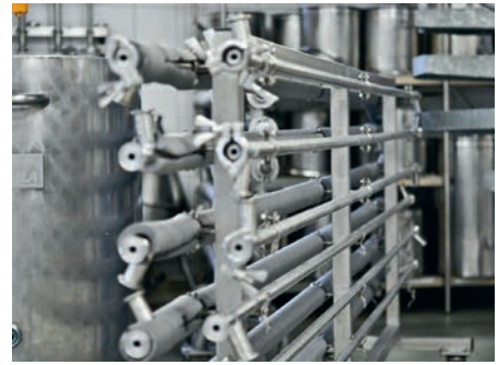
Das Projekt TurbuHeat beruht auf Wärmebehandlung von Milchproteinen mittels Rohrbündeltauscher. Das Team um Professor Beyrer hat Rohre mit unterschiedlichen Geometrien entwickelt, die eine optimale Mikropartikulation der Milchproteine und die Herstellung verschiedener Milchpulver ermöglichen.
