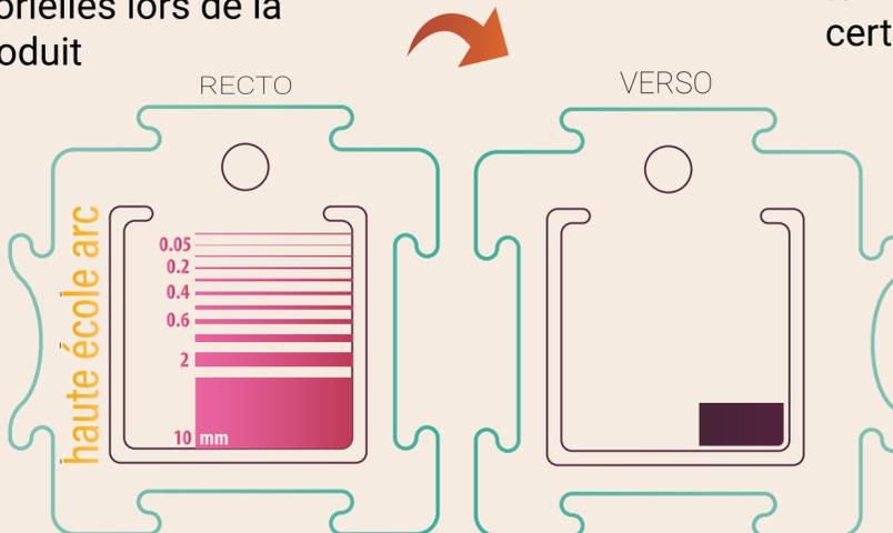
Echelle pour comprendre les capacités d'usinages, notamment pour le prototypage (élément variable selon le type de matériaux de l'échantillon)
